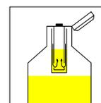
Immer einsatzbereite Dosierkammer für schnellen Zugriff
